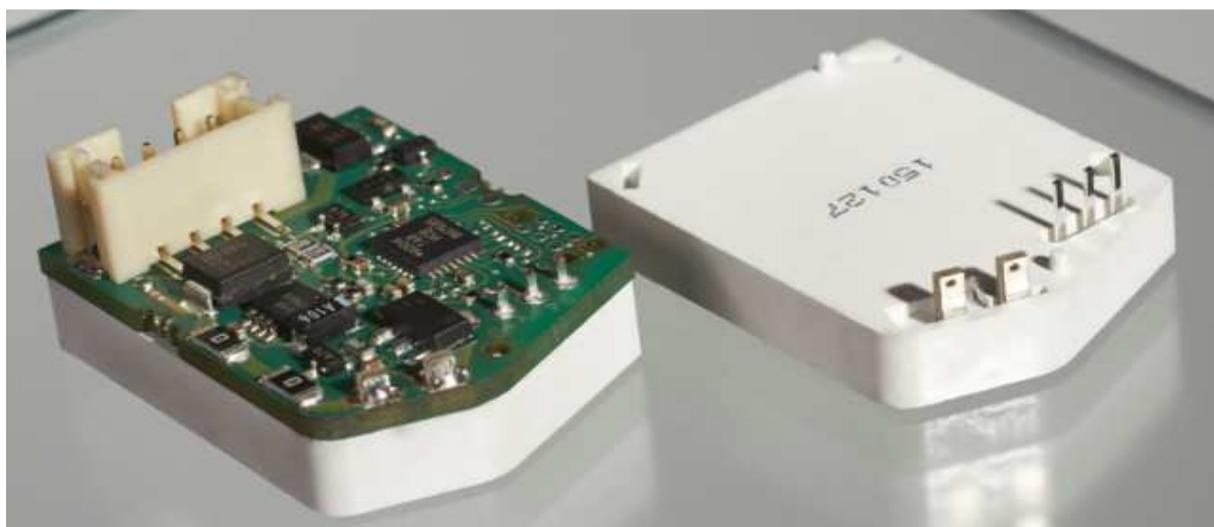
Image : touches ITO-Key avec le capteur capacitif, le rétro éclairage et l'électronique de gestion
